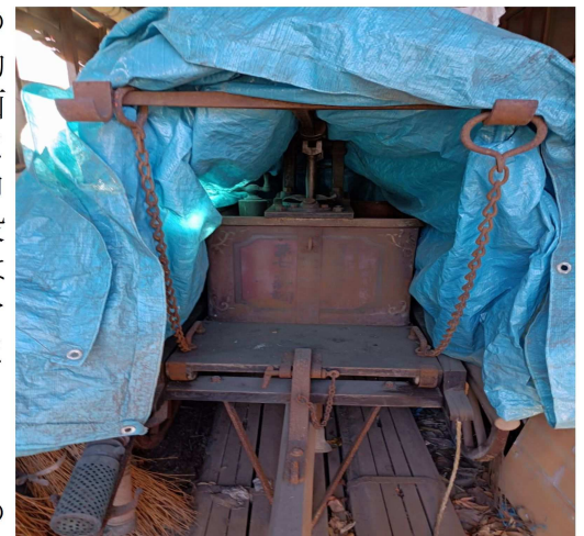
金属製手こぎの消防ポンプ
